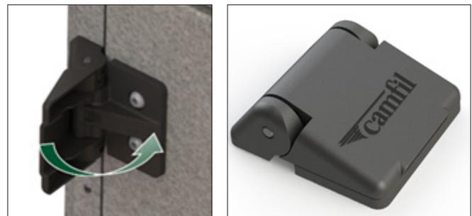
Scharniere mit Druckentlastung; so konstruiert, dass eine Beschädigung der Dichtung der Wartungstür durch Scherkräfte vermieden wird
